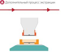
Активные и пассивные блоки состыкованы. Каждая половина клапана включает в себя одну половину дискового затвора. Каждый блок герметичен и не может быть открыт, если блоки не состыкованы.
