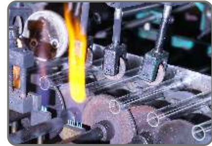
TEST TUBE MACHINE : 50000 pcs per shift Pasteur Pipettes MACHINE : 150000 pcs per shift
